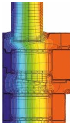
Rozkład izoterm w oknie MB-104 Passive Aero
