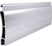
PE 41 wysokość profilu: 41 mm grubość: 8,5 mm
